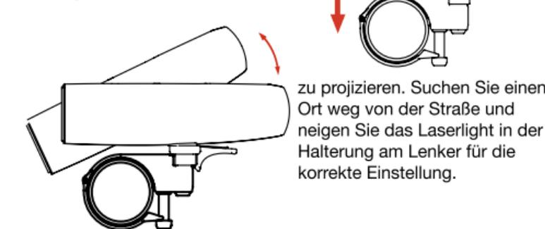
6. Sie sollten den Laser auch horizontal zentrieren. Lösen Sie die kleinere Schraube an der Halterung und und bewegen Sie das Laserlight horizontal.
